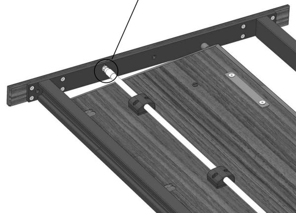
11. Wenn nötig, auch die gegenüberliegende Lagerung der Drehstange justieren. Dazu ggf. die Hülse nach hinten ziehen und dann mit einem Maulschlüssel die Mutter (SW13) etwas lösen. Nun durch Drehen der in der Traverse befindlichen Inbusschraube (SW2,5) die Höhe der Drehstange einstellen. Anschließend die Mutter der Drehstange wieder festziehen.
