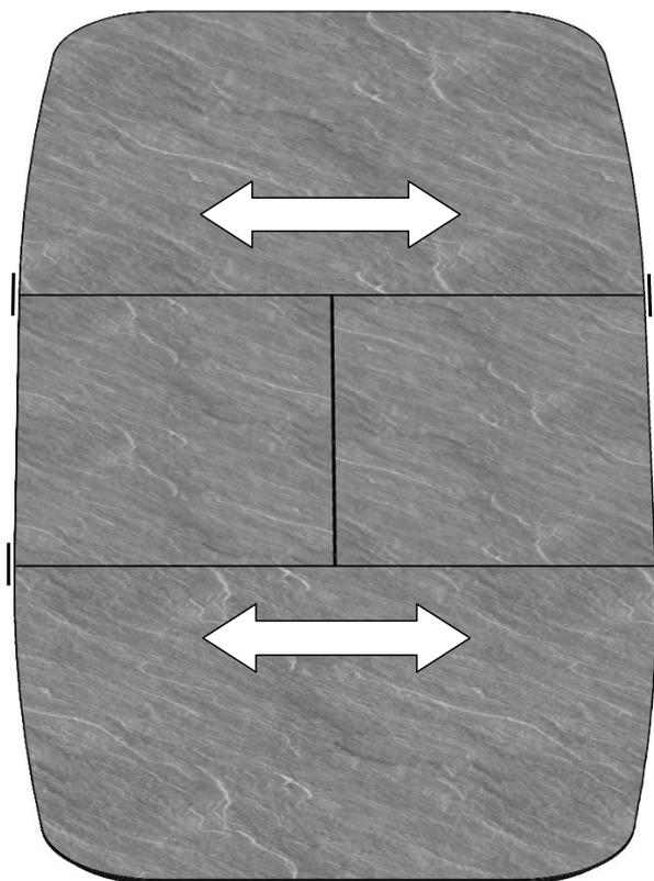
7b. Die beiden Hauptplatten Halbeile zur Klappeneinlage bündig ausrichten und danach die Verbindungsschrauben anziehen.
