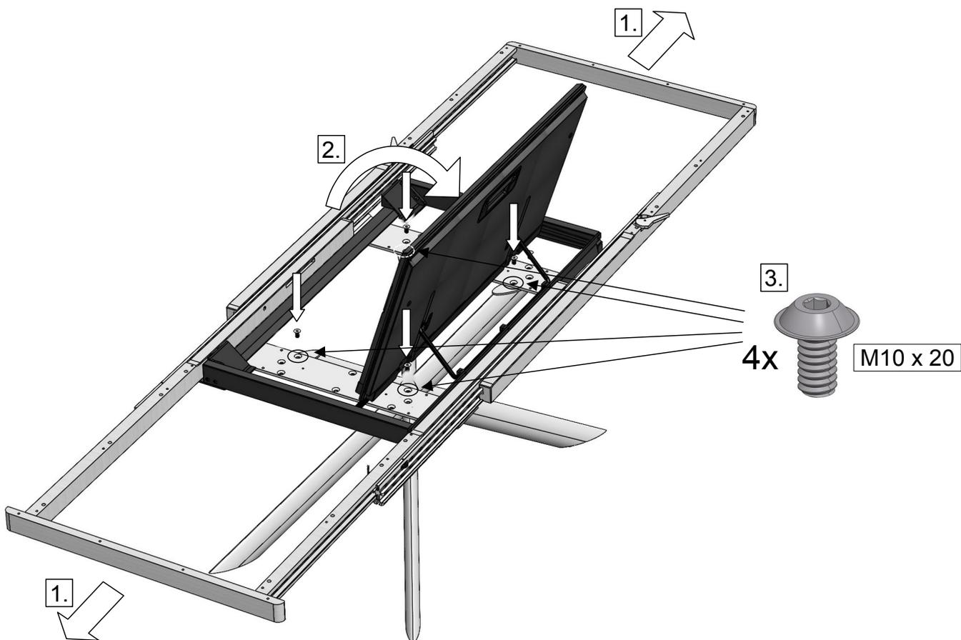
5. Den Oberbau ausziehen. Beide Teile der Klappeinlage hochklappen. Den Oberbau mit dem Unterbau mit insgesamt 4 Schrauben verbinden.
