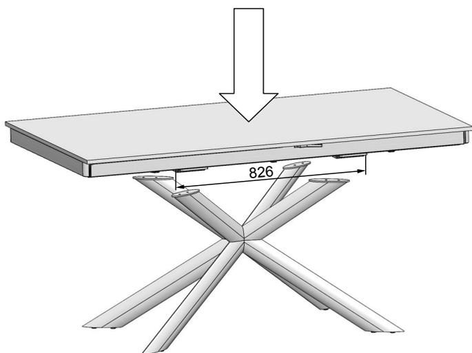
2. Den Oberbau mit den beiden Stahl-Trägerplatten auf dem Unterbau absetzen.
