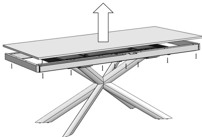
3. Die Transportplatte nach dem Lösen der Spax-Schrauben entfernen.
