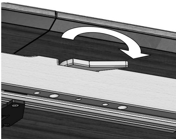
4. Vor dem Ausziehen auf beiden Seiten die schwarzen Bremshebel lösen.
