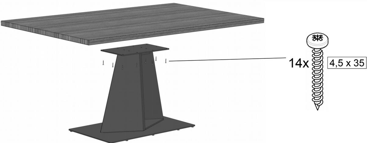
4. Die Platte auf den Unterbau auflegen, mittig ausrichten und dann verschrauben.
