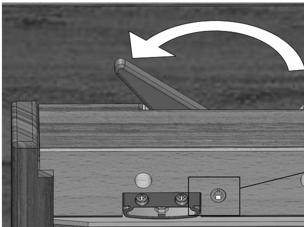
8. Vor dem Ausziehen auf beiden Seiten die schwarzen Bremshebel lösen.
