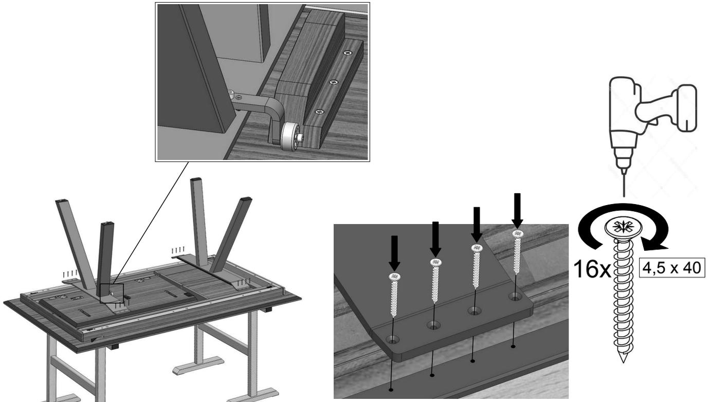
5. Die beiden Stahl-Platten des vormontierten Unterbaus nun wieder an den Oberbau schrauben.
