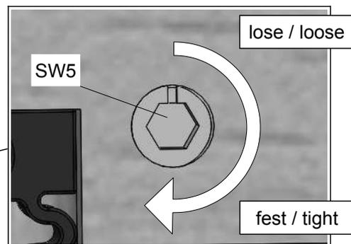
9. Kerbe nach außen: geringe Vorspannung
