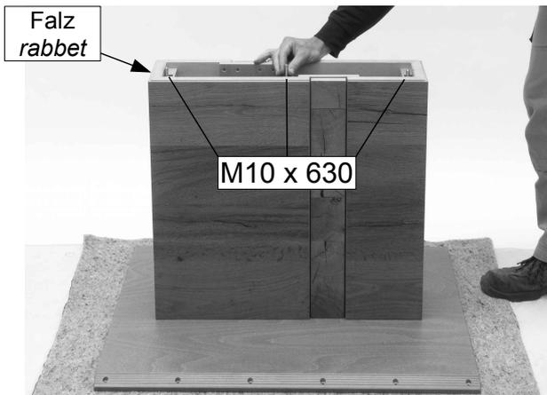
5. Die Unterbau-Säule über den Löchern des Plattenträgers positionieren. Die 3 Gewindestangen durch die Unterbau-Säule stecken und in den Plattenträger etwa 5 Umdrehungen eindrehen.
