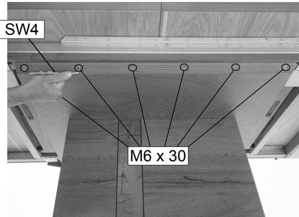
10. Auf beiden Seiten die zuvor ausgedrehten Schrauben wieder eindrehen.
