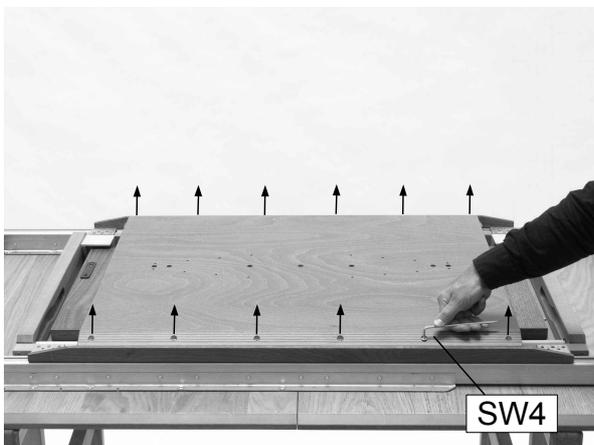
3. Die Schrauben des Plattenträgers mit einem Inbusschlüssel lösen.
