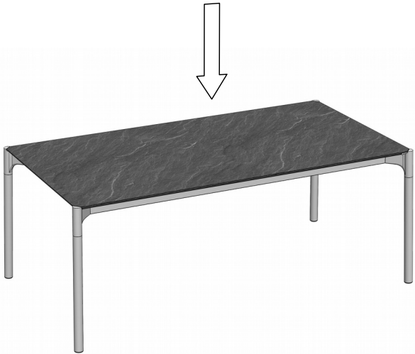
4. Die Platte auf dem Gestell auflegen... 4. Put the board onto the frame...
