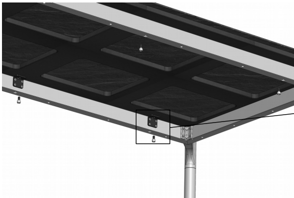
6. ...die Platte mit dem Rahmen verschrauben. 6. ... screw the plate to the frame.
