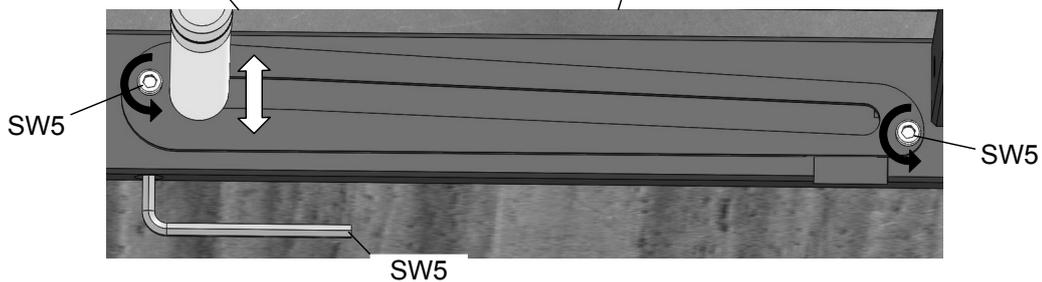
9. ... die beiden äußeren Inbusschrauben etwas lösen. Nun durch Drehen der inneren Inbusschraube die Höhe der Drehstange einstellen. Anschließend die beiden Inbusschrauben wieder festziehen.
