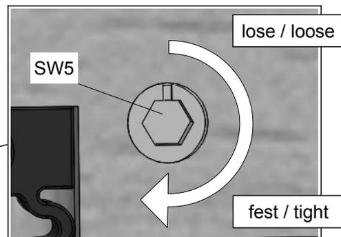
7. Kerbe nach außen: geringe Vorspannung
