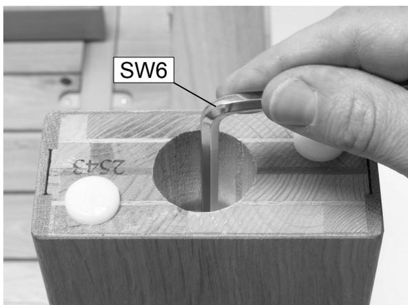
3. Die Hutmuttern mit dem beiliegenden Inbusschlüssel **fest anziehen**.
