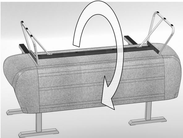
5. Die fertig montierte Bank drehen und auf den Boden stellen.
