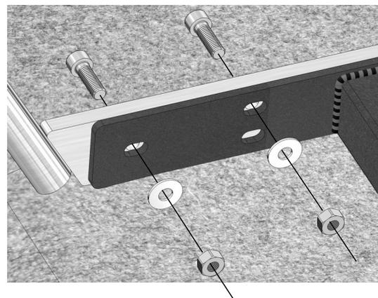
3. Beide Unterbauten an das Verstärkungselement schrauben.
