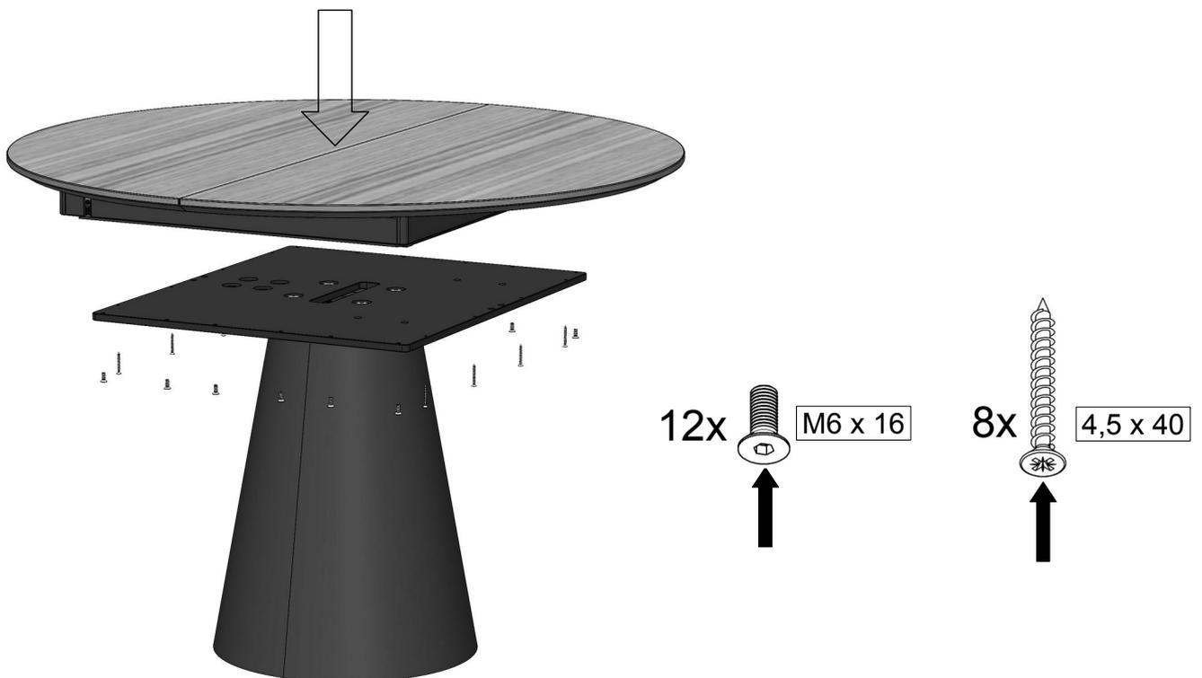
5. Den Oberbau auf den Unterbau stellen und mit 12 Inbusschrauben und 8 Spax-Schrauben verbinden.
