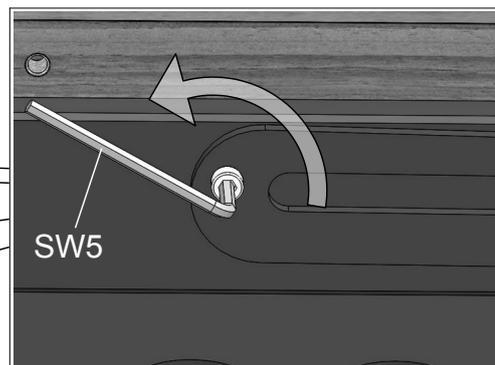
9c. Auf beiden Seiten die beiden Klemmschrauben etwas lösen.
