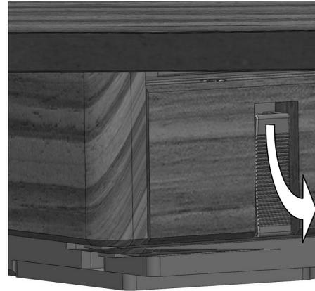
7. Vor dem Ausziehen auf beiden Seiten die schwarzen Bremshebel lösen.
