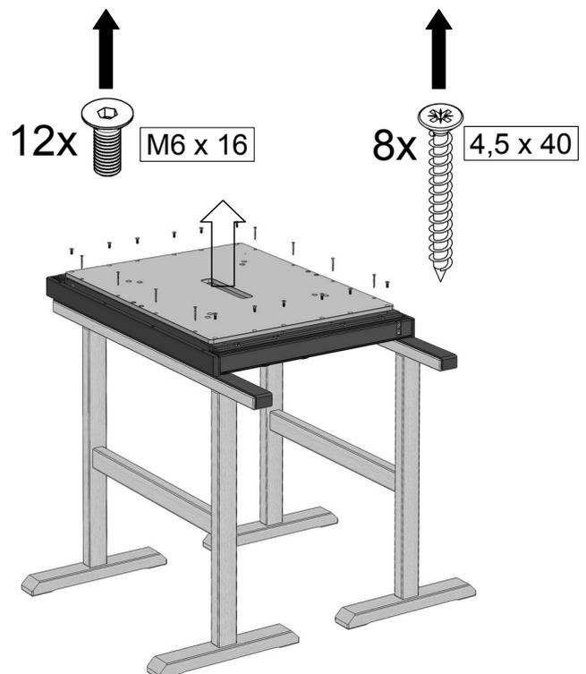
3. Den Oberbau umgedreht auf gepolsterten Montageböcken ablegen und den Plattenträger abschrauben.
