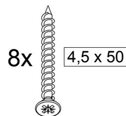
11. Die beiden Längszargen mit je 4 Spax Schrauben fixieren.
