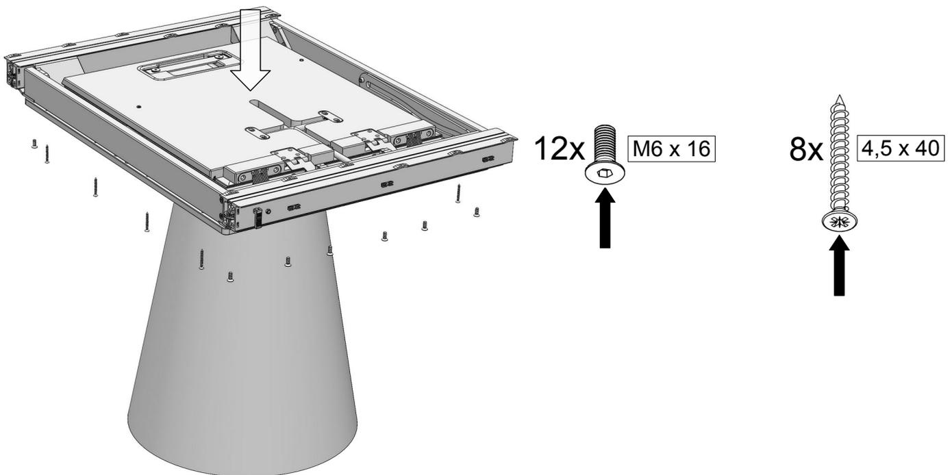
5. Den Auszugsrahmen auf den Unterbau legen und mit 12 Inbusschrauben und 8 Spax-Schrauben verbinden.
