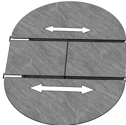
9. Die Halbteile zur Klappeinlage ausrichten. Schließlich die **Verbindungsschrauben anziehen**.
