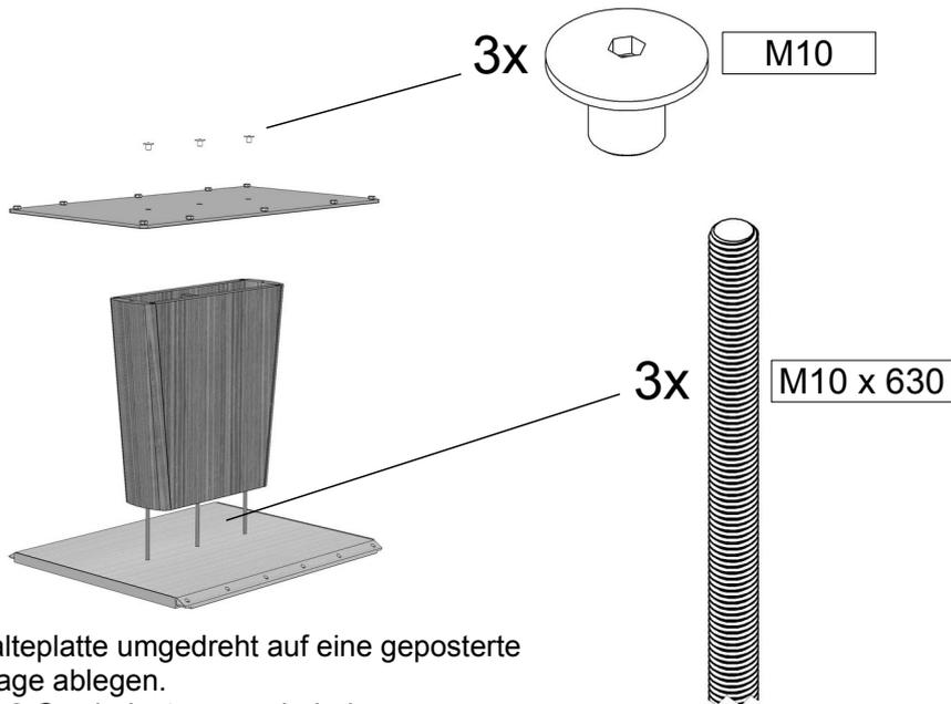
3. Die Halteplatte umgedreht auf eine geposterte Unterlage ablegen.
