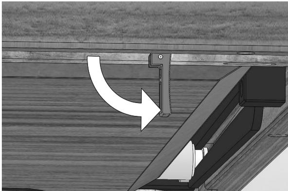
7. Vor dem Ausziehen auf beiden Seiten die schwarzen Bremshebel lösen.
