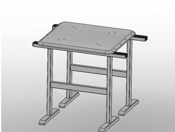
3. Die Halteplatte umgedreht auf gepolsterten Montageböcken ablegen. 3. Put the holding-plate upside down onto padded assembling trestles.
