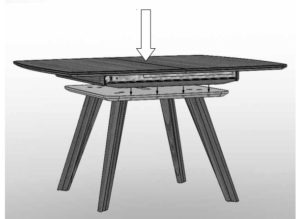
6. Den Oberbau auspacken und so auf dem Unterbau positionieren, dass die Bohrungen fluchten. 6. Unpack the table top and put it onto the base so that the bore holes align.
