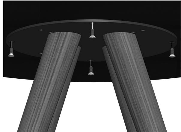
5. Die Tischplatte auf den Unterbau legen, so dass die Bohrungen der Stahlplatte mit den Gewindebuchsen der Tischplatte fluchten. Den Unterbau mit dem Oberbau mit 4 Senkkopfschrauben verbinden.
